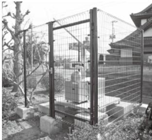
↑測定は、地表1.0m、24時間常時計測、電光掲示板に測定値が表示
