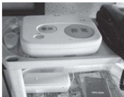
▲緊急通報装置
