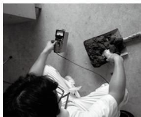
▲脱水汚泥の放射線量の検査状況
