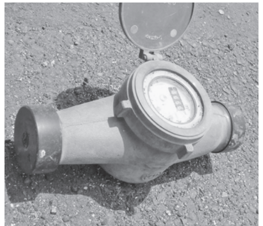
▲水道メーター
