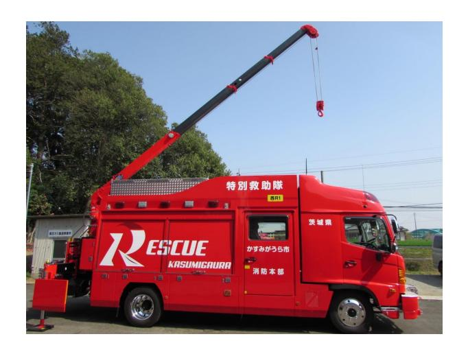
クレーン装置は旧型車両では3段ブームで最大作業半径は7.69m でしたが、新型車両では、4段ブームとなり作業半径が最大8.9mと なっており広範囲で重量物を吊ることができるようになっております。 最大クレーン容量は2.9 t となっています。
