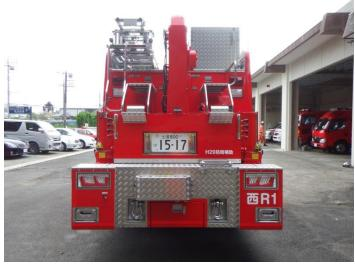
ウインチ装置は、全方位25度まで対応し、乱巻キンク等が発生しない構造になっています。ワイヤーの長さは60mあり、フロント 常時5 t、リア常時10tの能力となっています。また、ワイヤーの巻き取る 速度は、無段階にコントロールできる構造となっています。
