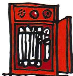
屋内消火栓設備
