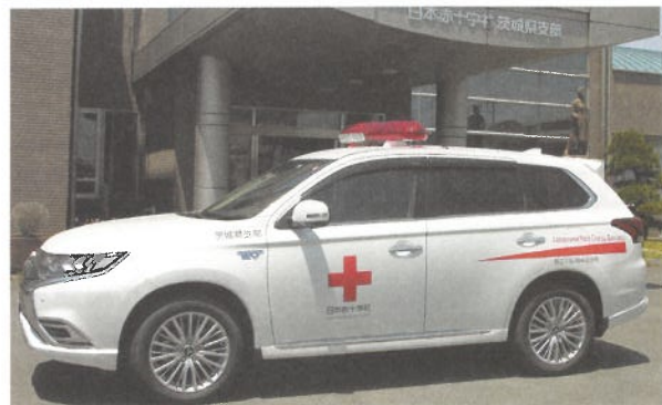
被災地で電源供給が可能な車両
