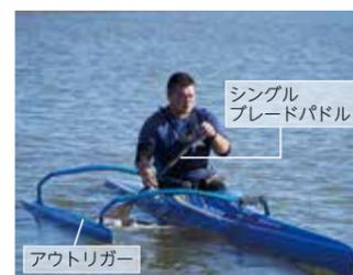
私は、片側に浮力体 (アウトリガー) の付いた「ヴァー」と呼ばれるカヌーに挑戦しています。ヴァーはカヤックより安定性が高くなる一方、直進性能が低くなる競技で、よりテクニクが必要となります。カヤック・ヴァーともにコックピットの中にはシートがあり、選手の障がいに合わせてカスタマイズされ、シートの調整が重要なポイントです。漕ぎ方は、シングルブレードパドルを使って、軌道を「J」の文字にする漕ぎ方「Jストローク」で進みます。片側だけで漕いで真っ直ぐに進むためには、高いパドルリング技術が求められます。
