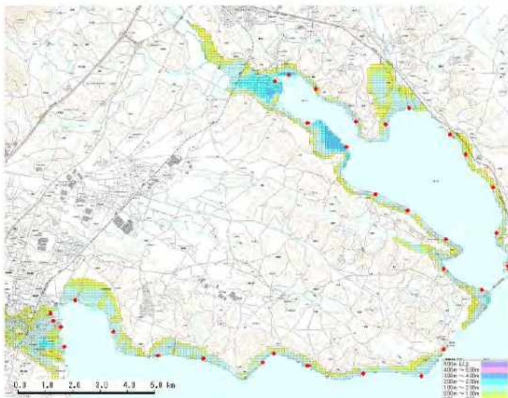
図 115 霞ヶ浦湖岸破堤想定による最大浸水の状況（出典：かすみがうら市地域防災計画 2-2 頁）
