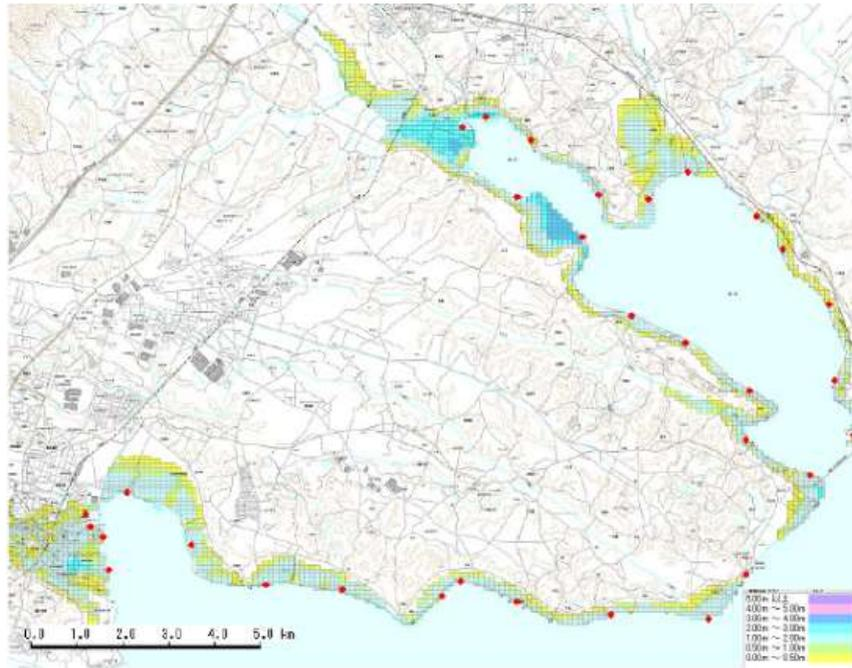
図 116 霞ヶ浦湖岸破堤想定による最大浸水の状況（出典：かすみがうら市地域防災計画 2-2 頁）
